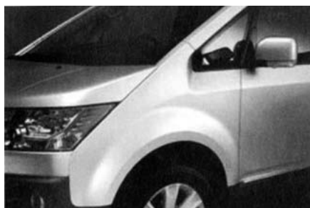
図2 樹脂フェンダの例：デリカD：5
