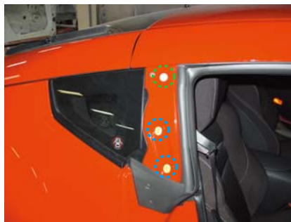
ロックピラーフィニッシャを取外した状態
