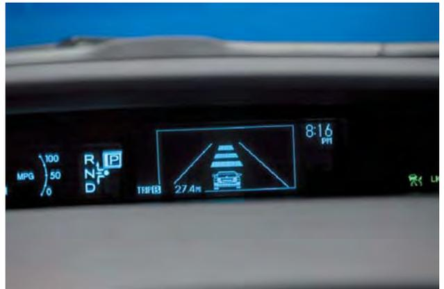
車両検知用のミリ波レーダをフロントのトヨタエンブレムに内蔵する(右写真は先行車両への追突を防ぐプリクラッシュセーフティシステムの動作画面)。
