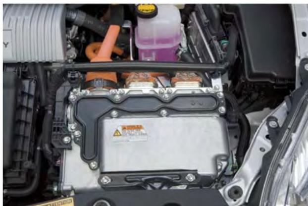
モータ自身の電線の巻き直しなどで最高出力を40kWから60kWに引き上げ、電圧は現行の500Vから650Vへ高めたパワーユニット。
