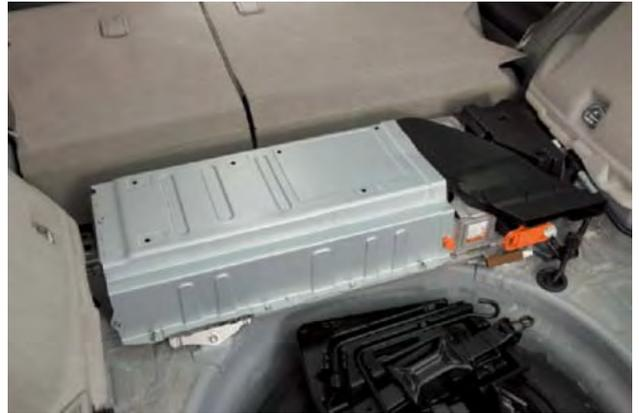
4：6の分割可倒式リヤシート、現行から約30L拡大したラゲージスペース(写真右は、リヤシートバック後側に格納されるニッケル水素電池)。
