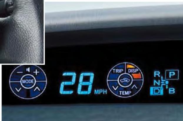
ステアリングホイールに設けられたタッチセンサ(スイッチ)に触れている指の位置をセンタメータに表示することで視線移動を減らす「タッチトレーサシステム」。
