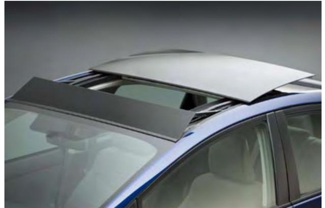
ムーンルーフの後側半分がソーラパネルとなっており、直射日光の下に駐車した際には、太陽電池が発電した電力でファンを回し、室内換気を行って室温上昇を防ぎます(京セラ製の太陽電池を搭載し、発電した電力で室内を換気する「ソーラベンチレーションシステム」)。写真右は、前側半分のスライディングルーフ部分を開けた状態。
