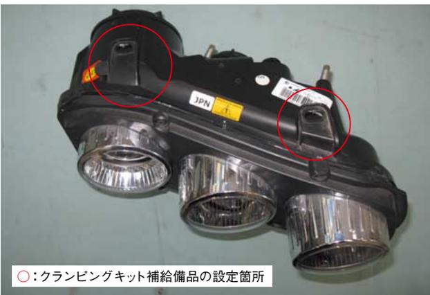
○:クランピングキット補給部品の設定箇所
