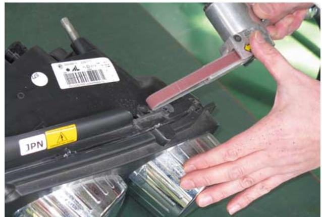
ベルトサンダやカッタ、スクレppaを使用して、切断後の残部を慎重に整形します。
