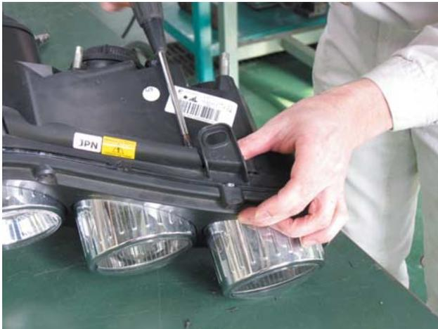
スクリューを使用して、クランピングキットを取付けます。
