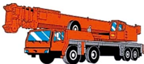
（単車の一例） トラッククレーン
