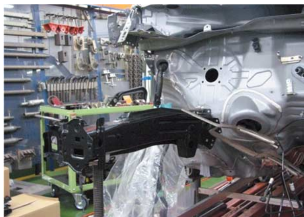
写真10 GE#型 フロントサイドフレーム仮付け状態
