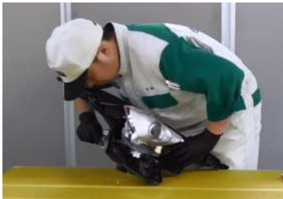
写真 13. ヘッドランプユニットの取付け
