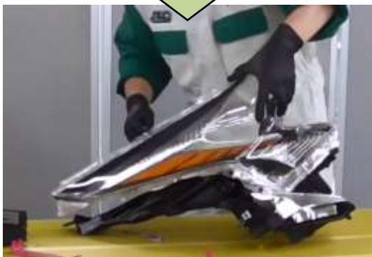
写真 5. ヘッドランプレンズの取外し
