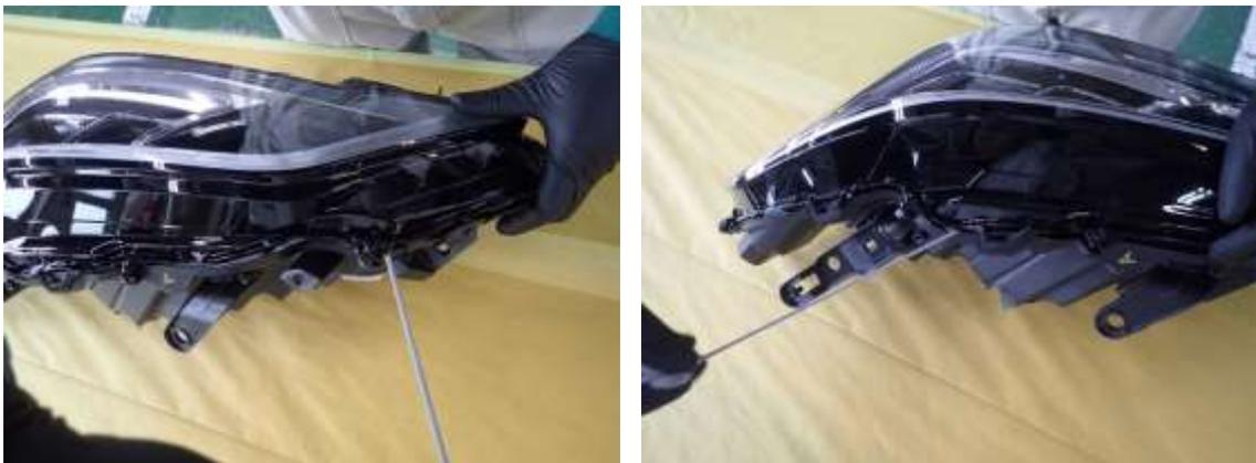
写真 3 : ガスケット引出し
