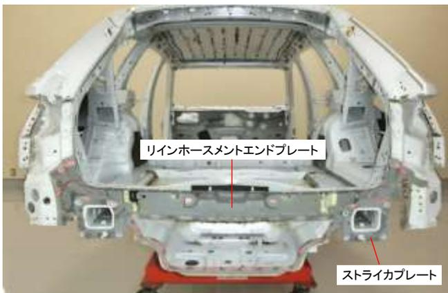
リヤクロスパネル、ラインホースメントエンドプレート、テールライトマウンティング、インサートプレートロア取外し状態
