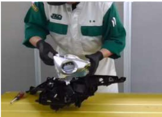
写真 9. ヘッドランプユニットの取外し
