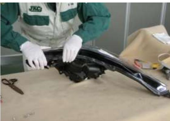
写真 17. ヘッドランプレンズの組付け
