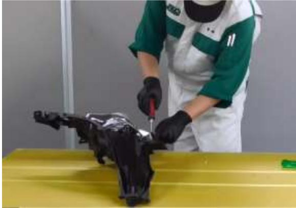
写真 14. リフレクタの取付け
