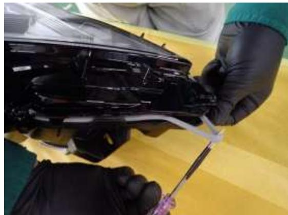
写真2：ガスケット引出し
