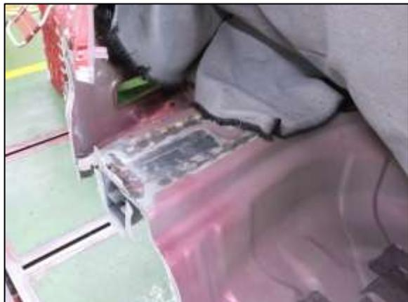
④ バックパネルを仮付けして、各部品との建
