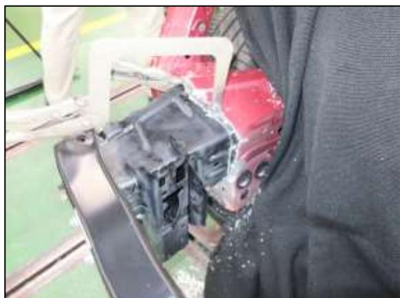
③ 右ラジエータサポートサブ Assy、ラジエータサポートサブ Assy アップ、フロントクロスメンバサブ Assy、フロントバンパラインホースメントを取付けて位置関係を確認しました。
