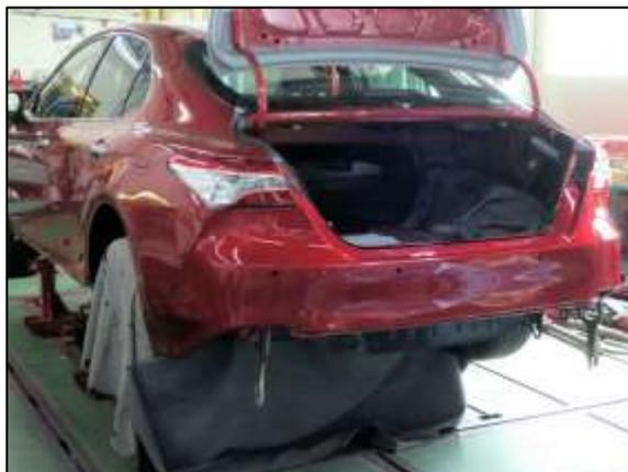
⑤ 各部品の建付けが基準と一致したので関連部品を取外して本溶接し、後部骨格修理作業が完了しま
