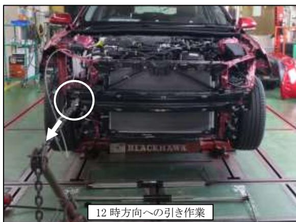
② 次に、右フロントバンパエクステンションサブ Assy 先端をカットし、チェーンを掛けて12時方向へ引き作業を行いました。
