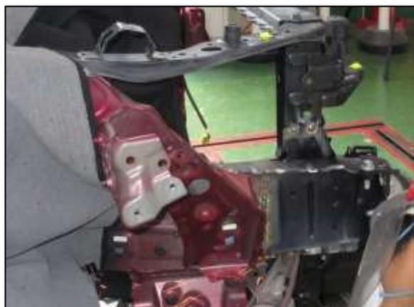
⑤ 外装部品を取付けて各部品の建付けを確認し、前部骨格修理作業が完了しました。
