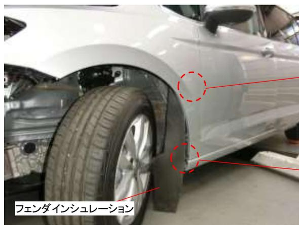
フェンダインシュレーションを取外し、ホイールハウス内側よりフロントフェンダ取付ボルトを取外します。
