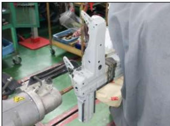
(9) 外装部品を取付けて各部品の建付けを確認し、前部骨格修理作業が完了しました。
