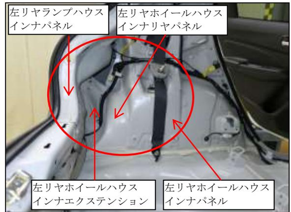
③ 左リヤホイールハウスアウトパネル、左リヤホイールハウスインナリヤパネル、左リヤフロアサイドメンバリヤエクステンションが損傷（赤丸部）していました。
