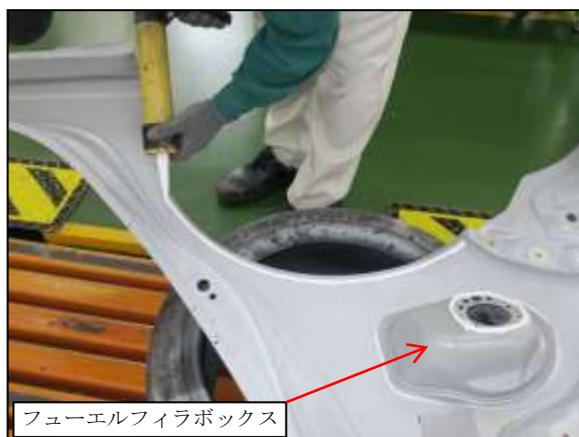
(11) 左クォータパネル、左リヤランプハウスアウトパネル、左リヤランプハウスインナパネル、バックパネルを仮付けしました。
