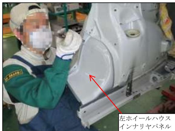
(3) 左クォータパネル、左リヤランプハウスアウトパネル、左リヤランプハウスインナパネルを仮付けしました。
