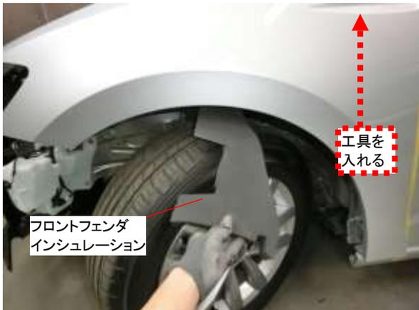
フロントフェンダインシュレーションを取外し、ホイールハウス内側から工具を入れて、フロントサイドガラス **FIXED** 部分のフロントフェンダ取付ボルトを緩めます。
