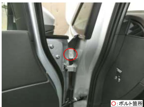
フロントドア開口部より、フロントフェンダ取付ボルトを取外します。
