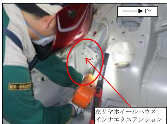
(14) 左クォータパネル、左リヤランプハウスアウトパネル、左リヤランプハウスインナパネル、バックパネルを全て溶接し、後部修理作業が完了しました。
