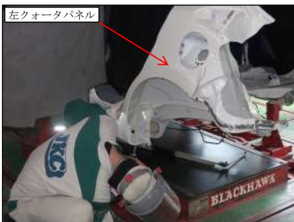
(3) 左リヤランプハウスアウトパネル、左リヤランプハウスインナパネル、左ホイールハウスインナリヤパネル、左リヤフロアサイドメンバリヤエクステンションを取外した状態の写真。
