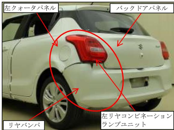
② バックパネル、左リヤランプハウスアウトパネルが損傷（赤丸部）していました。
