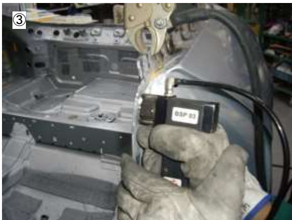
ドロープイン溶着状態
