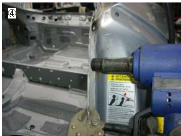
パンチリベットを取外したボディ側の状態
