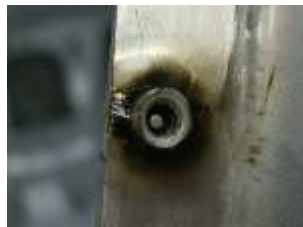
パンチリベットを取外したボディ側の状態
