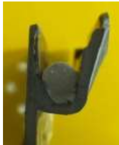
ハウジング溝 断面図
