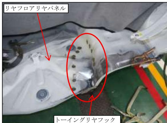
(2) 車両にバックパネルを仮付して、外装部品を取付け、関連部品の建付けを確認しました。
