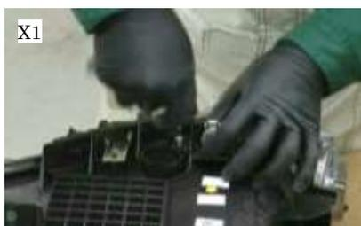
④ヘッドランプブラケットの補給部品に同梱されているスクリューで、ヘッドランプに設けられている受け穴にヘッドランプブラケットを取付けます。
