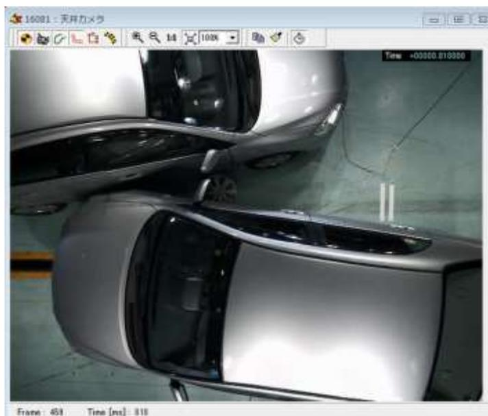
(7)ムービングバリア（可動バリア）による停止車との衝突（角度 60°、マツダアクセラ）
