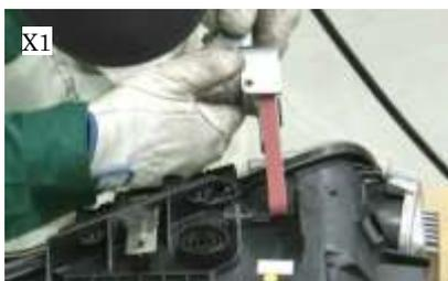
②切断後、ヘッドランプブラケットを合わせながら取付け可能な断面形状になるように修正します。整形作業はベルトサンダ等を用いています。
