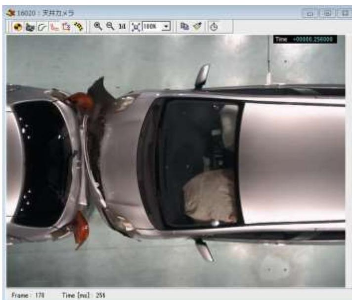
(3) 同クラス車による停止車両右側面への衝突
