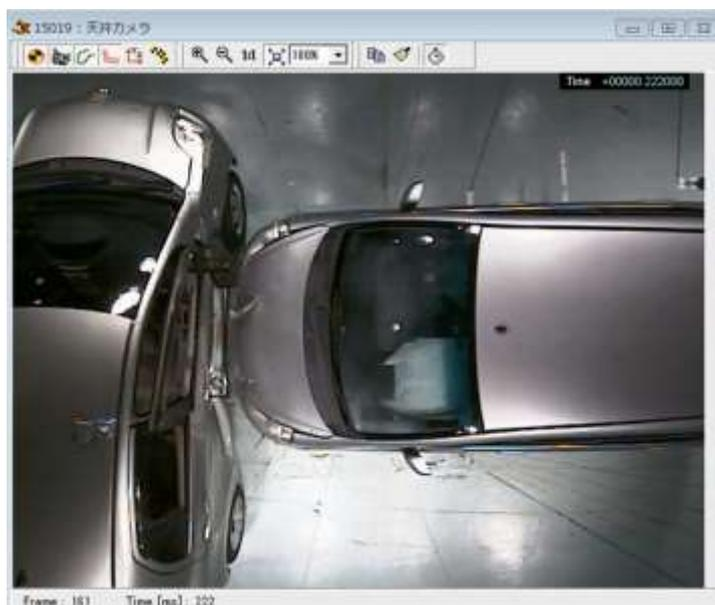
(4) 同型車による停止車両右側面への斜め衝突（角度  $10^\circ$ 、トヨタカローラアクシオ）
