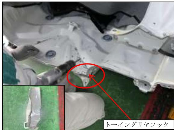
(3) バックパネル取外し後のリヤフロアリヤパネルには、まだ○部分に損傷が見られます。
