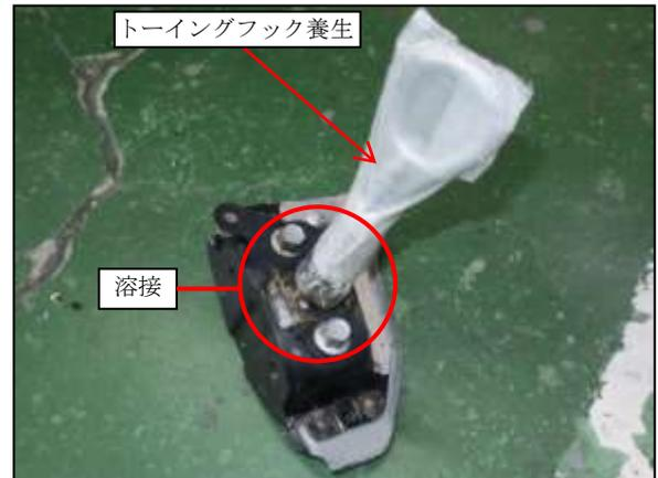
(3) 組付けた左右エプロンサイドメンバエクステンションを、取付位置を計測して溶接しました。
