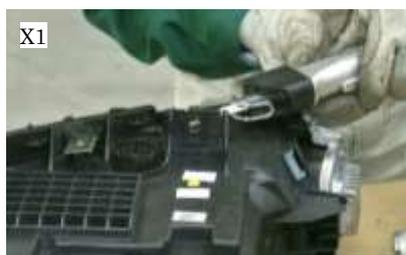
①ヘッドランプブラケットをヘッドランプに合わせて取替範囲を確認したのちに、損傷部を切断します。取替範囲の把握を誤ると、取付けた後のブラケットのぐらつきや、後の整形作業で時間がかかるため注意が必要です。
