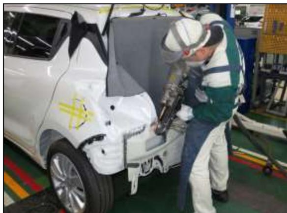
(4) 溶接した部分を下処理防錆して後部修理作業が完了しました。
