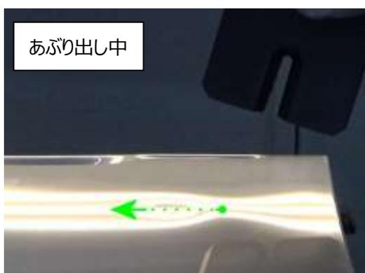
加熱直後にツールをパネルから外します。加熱により、凹みが引上げられ、加熱前より凹みが小さくなっていることが確認できます。
