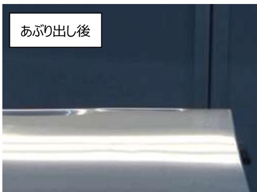
加熱が終わり、冷却後に凹みを確認をします。あぶり出しにより、凹みが引上げられ小さくなっている様子が確認できます。
