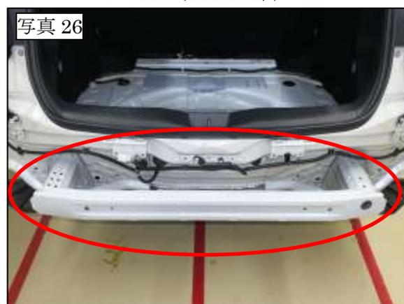
6時方向から低速での衝突入力を受けた時の車両の損傷を比較してみると、リヤバンパラインホースメントとクラッシュボックスが付いている仕様のプリウス(ZVW50系)同様、バックドアやボデーローバックパネルサブ Assy に損傷がなく損傷範囲が狭くなっています。(写真 27、28)
