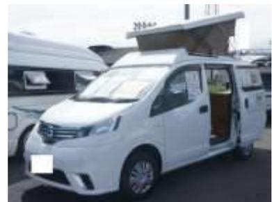
上記のいずれのポップアップルーフも走行時は畳んで収納し、使用時に持ち上げる仕組みです。使用する際には、車体に固定しているベルト 2ヶ所を外し、取手（右写真の赤丸部）を掴んでルーフを持ち上げます。手動で開閉するタイプが多く、1 人でも容易に操作できる程度の軽さです。
