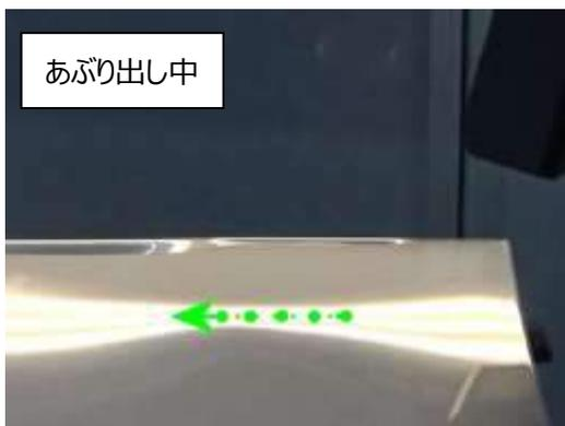
5回の加熱を終えた直後の写真です。加熱部の緑○印を頂点とし、緩やかな凸面が形成されたため、蛍光灯の光が周辺より狭くなっています。
