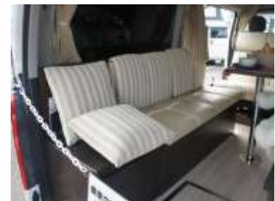
一方、8 ナンバ車に限っては、横向きシートの装着が認められますが、その他 8 ナンバ車の要件として、就寝設備や水道設備、炊事設備等が必要となるだけでなく 160cm 以上の室内高も確保する必要があります。そのためポップアップルーフを装着するか、床を掘り下げる等の改造が必要となり、結果的に価格の上昇となります。
