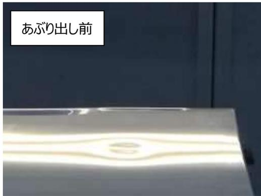
写真は、「あぶり出し前」のパネルの状態です。写真中央付近に凹みが確認できます。損傷面積は1dm<sup>2</sup>以下です。
