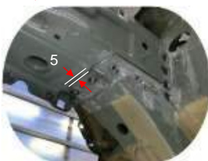
インナエンジンキャリア後部カット位置 リヤエンジンキャリアパネル端部より：5mm
