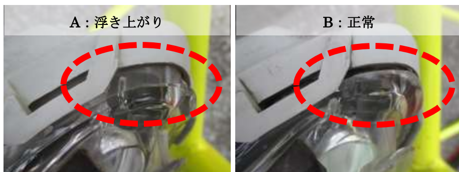
写真 1：浮き上がりによる圧着不足と正常圧着
