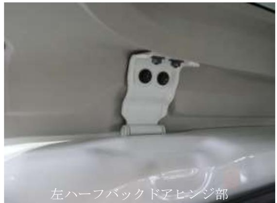
なお、ハーフバックドアは樹脂製で、新品部品は塗装済みで補給されます
