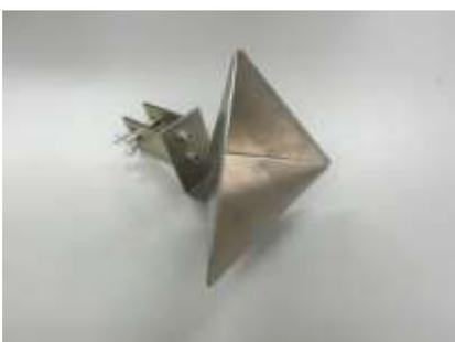
レーダ軸調整用レーダリフレクタ
