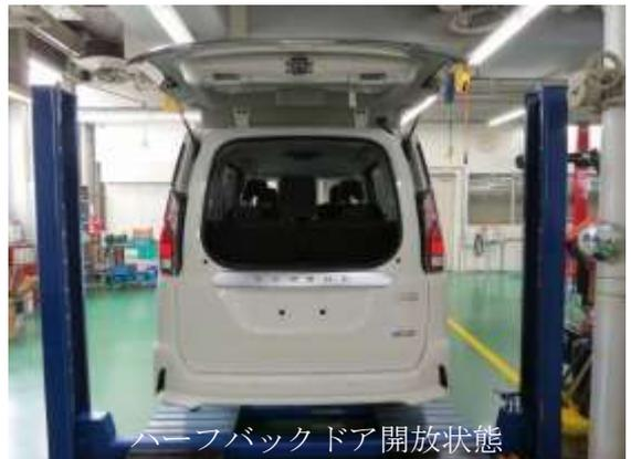
ハーフバックドアのみの開閉ができることによって、後方に車両や、背の低い壁がある場合でも荷物の出し入れを行うことができます。
