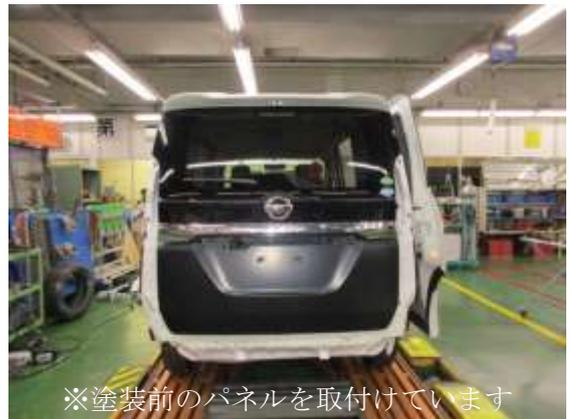
取付け後は、バックドアの面差およびクリアランスが基準値になるように調整し、規定トルクで締付け取付作業は完了です。
