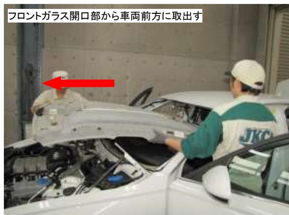
左写真は、フロントガラスを取外した状態。自動防眩インテリアミラー、インテリア&リーディングライト、照明付きミラー&カバー付きサンバイザ、Aピラートリムアップ等の付属品はフロントガラスの作業で取外される。
