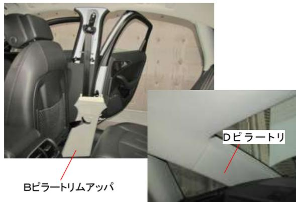
インテリアライト、Grabハンドル、BピラートリムアップおよびDピラートリムを取外す。ヘッドライニングをフロントガラス開口部から車両前方に取出す。
