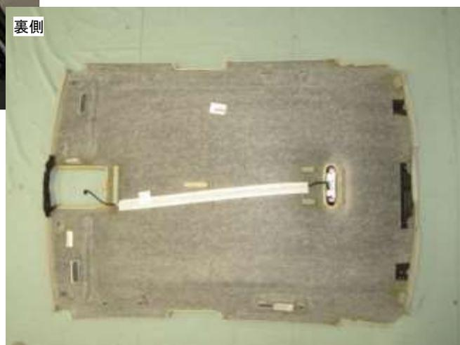
ヘッドライニングの取外しは、フロントガラス開口部、リヤウインド開口部のどちらからでも取出す作業が可能です。
