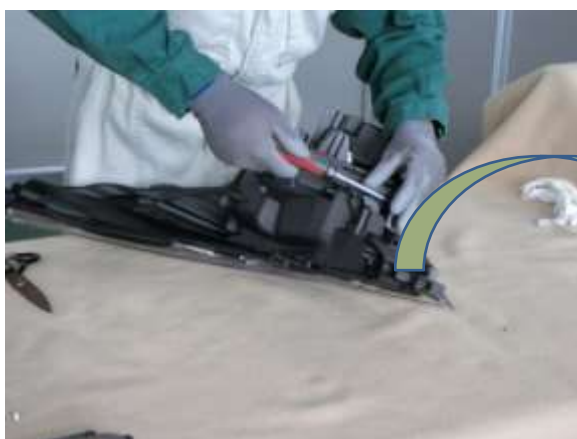
写真 5 トルクスクリューおよびスクリュー取外し
