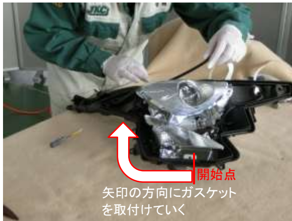
写真 13 ヘッドランプレンズガスケットのセット
