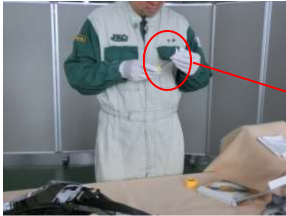
写真 12 ドライバへ離型紙を貼付け
