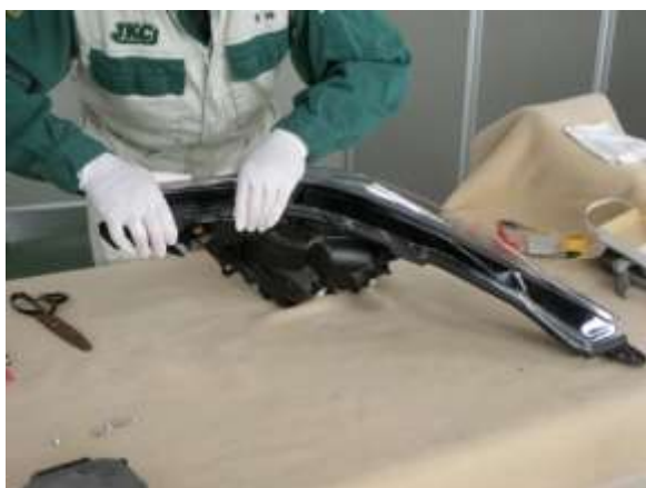
写真 15 新品ヘッドランプレンズの取付け
