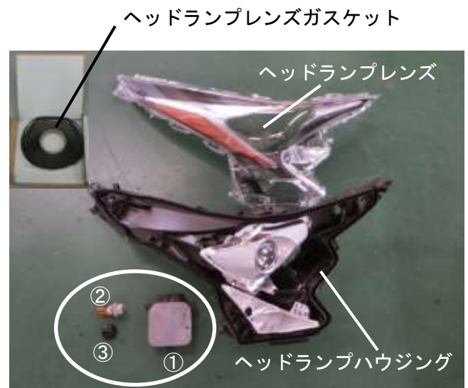
写真2 ヘッドランプレンズ取替作業での部品構成
