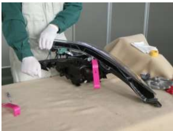
写真 8 ヘッドランプレンズの取外し
