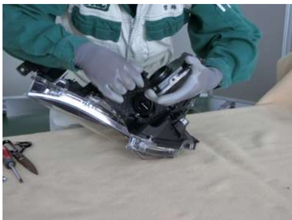
写真3 ヘッドランプコンピュータ No1 の取外し
