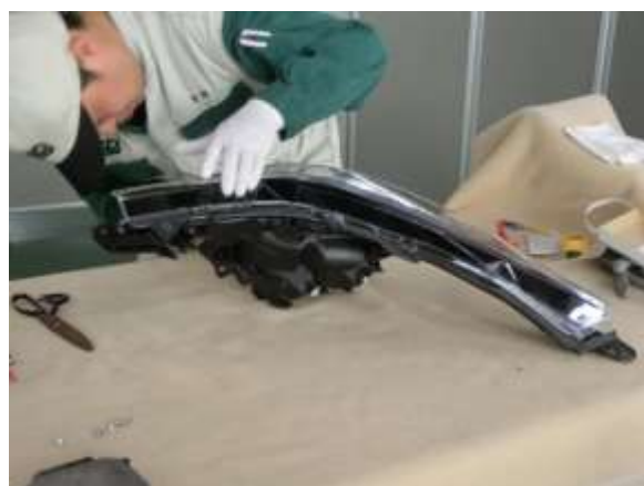
写真 16 新品ヘッドランプレンズの取付状態確認
