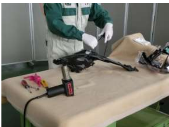
写真 11 ヘッドランプレンズガスケットの除去
