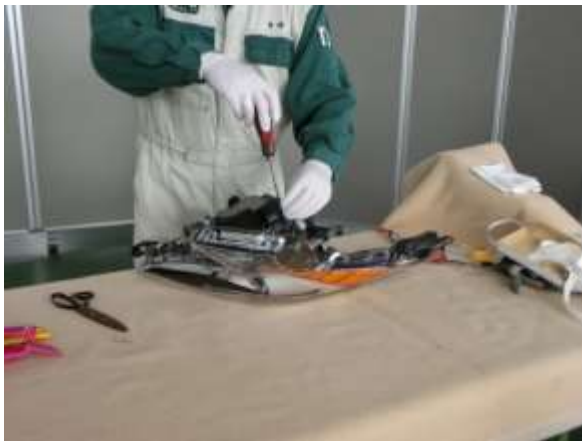
写真 18 ヘッドランプコンピュータ No1 の取付け
