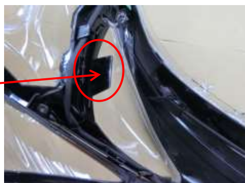
写真 10 ヘッドランプレンズ裏面の突起部
