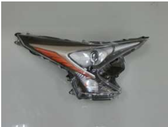
写真 20 取替作業完了ヘッドランプ Assy 表面
