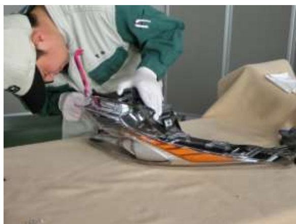
写真 7 ヘッドランプレンズ接合部のツメ(8カ所)取外し
