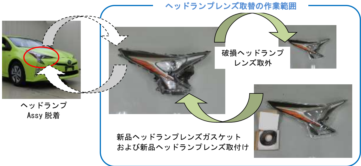
図1 ヘッドランプレンズ取替作業の範囲
