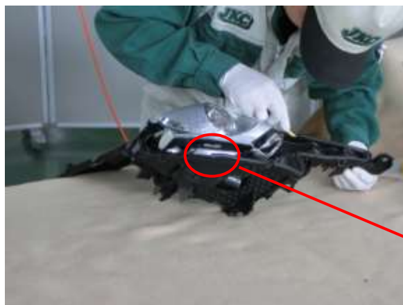
写真 14 ヘッドランプレンズガスケットの押込み
