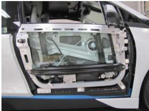
リアドアアウトパネル取外し状態
