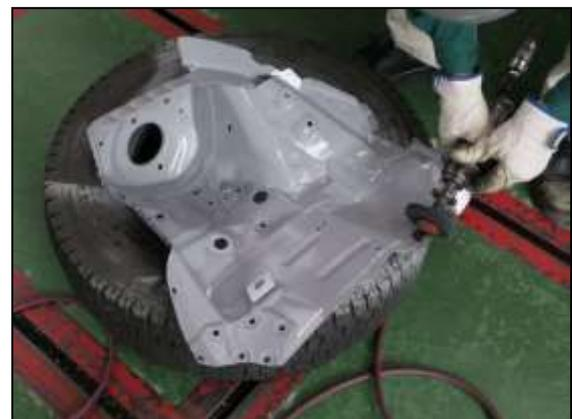
(5) 右フロントサイドメンバサブ Assy を、寸法に合わせて仮付けして溶接します。
