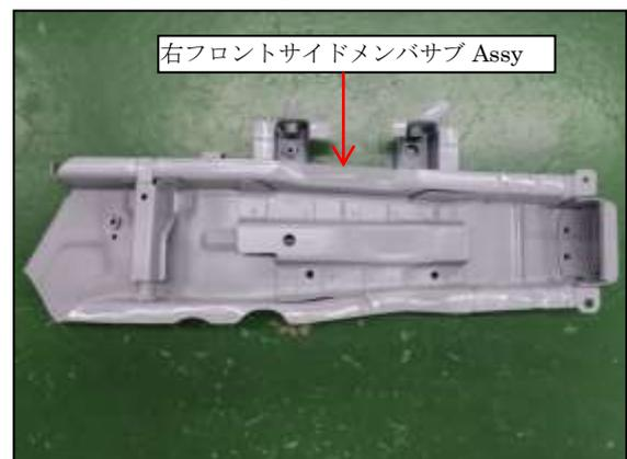
(3) 取付前に右フロントサイドメンバサブ Assy に、プラグ溶接穴をあけます。
