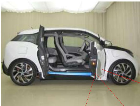
ドアは、(フロント・リヤ共通) 両側観音開き構造でドアアウトパネル、ドアおよびフレームトリムパネルで構成されています。
