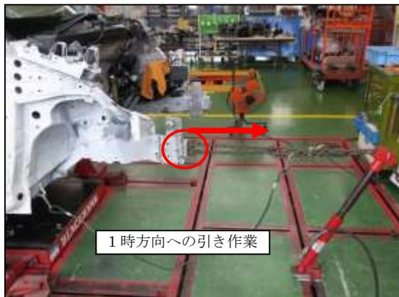
② 右フロントサイドメンバサブ Assy とダッシュパネルサブ Assy の取付部を引き出すため、右フロントサイドメンバ前部を粗切りしてクランプし、引き作業を行いました。
