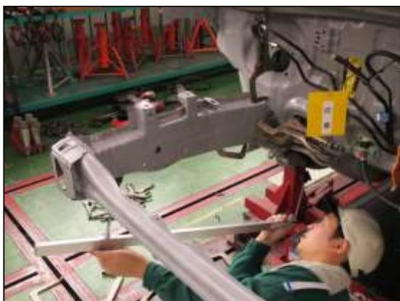
(6) 右フロントサイドメンバプレートサブ Assy を、寸法に合わせて仮付けして溶接します。
