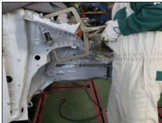
(7) 右ラジエータサポートサブ Assy を寸法に合わせて仮付します。
