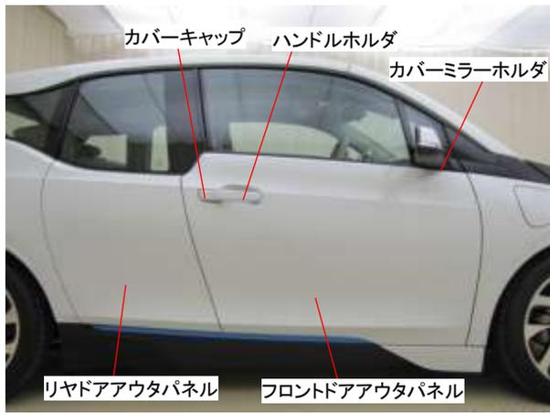
フロントドアアウトパネルおよびリヤドアアウトパネルはドアトリムパネルを取外さなくても脱着が可能です。
