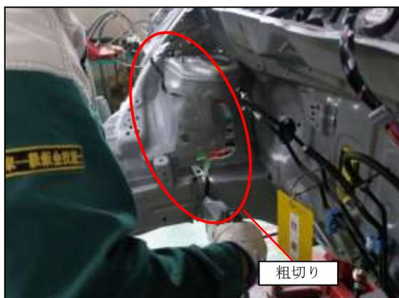
(2) 粗切り後に、ボデー側に残った右フロントサイドメンバプレートサブ Assy、右フロントサイドメンバサブ Assy を取外しました。
