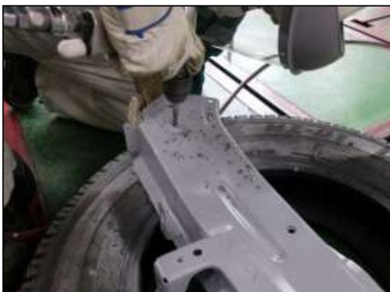
(4) 取付前に右フロントサイドメンバプレートサブ Assy に、プラグ溶接穴をあけます。
