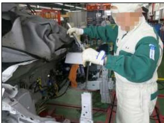
(8) ラジエータサポートアッパ、フロントバンパラインホースメント、左右フロントフェンダパネル、フードを取付けて全体の建付けを確認します。
