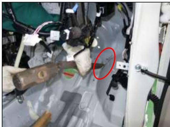
④ 引き作業およびハンマ粗出し作業によりダッシュパネルサブ Assy の変形が減少しました。
