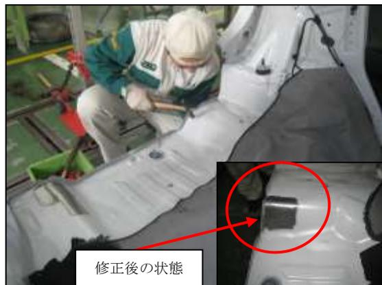
(2) リヤフロアリヤパネル(右側)を6時方向へ引きながらハンマリングにて修正しました。
