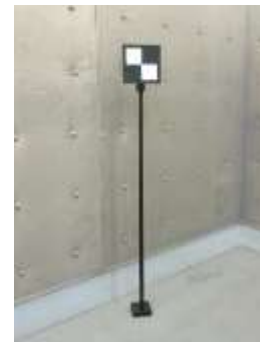
フォワードレコグニションカメラ光軸調整用ターゲット
