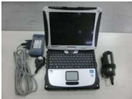
故障診断機材 (GTS をインストールした PC、インタフェースと接続ケーブル)
