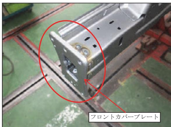
⑧アース線を取付けるウェルドナットは別部品のため、取外した右フロントサイドメンバから取付位置を測り取り、ウェルドナットを溶接します。
