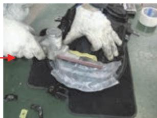
切断後、ベルトサンダ等で取付可能な形状に修正する。
