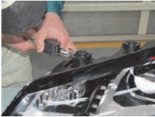
リペアキットに合わせて損傷部を切断する。
