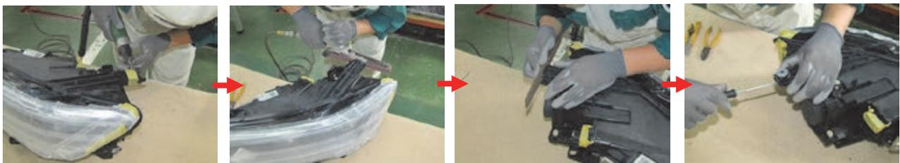
リペアキットに合わせて損傷部を切断する。
