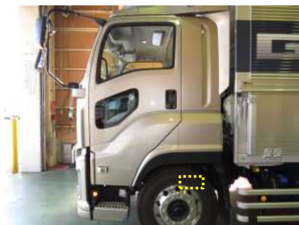
外観から見た打刻位置
