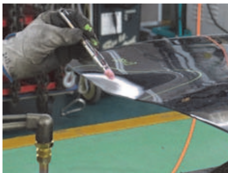
サーモクレヨンによる温度管理
