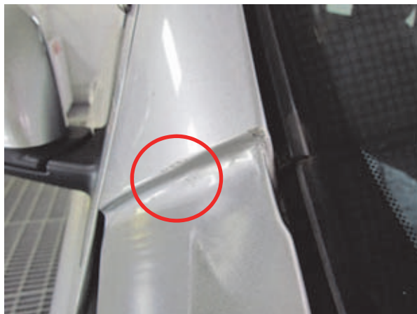
フロントフェンダとの干渉によりフロントピラーが損傷したと想定
