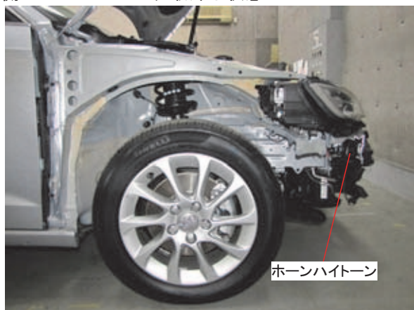
右側フロントフェンダ取外し状態
