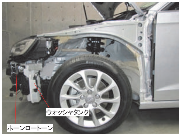
エアコンコンデンサ、ラジエータ、ロックキャリア取外し状態
