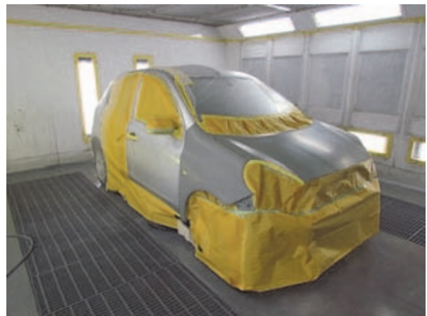
通常の補修塗装作業であれば塗装範囲およびマスキング範囲が大きい
