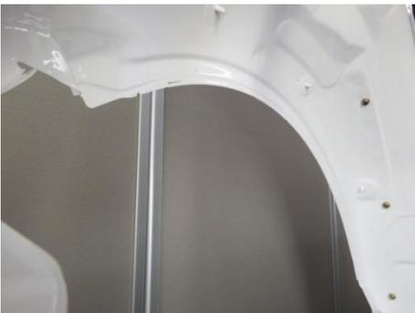
クォータパネル取外し後のホイールハウスアウトの様子です。ホイールハウスアウトに変形などの損傷はありませんでした。
