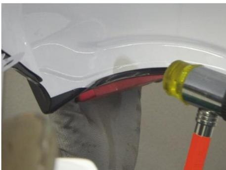
ヘミングツールを取付けるために、ヘミング加工開始位置を2~3cm程度ハンマリングでヘミング加工しておきます。
