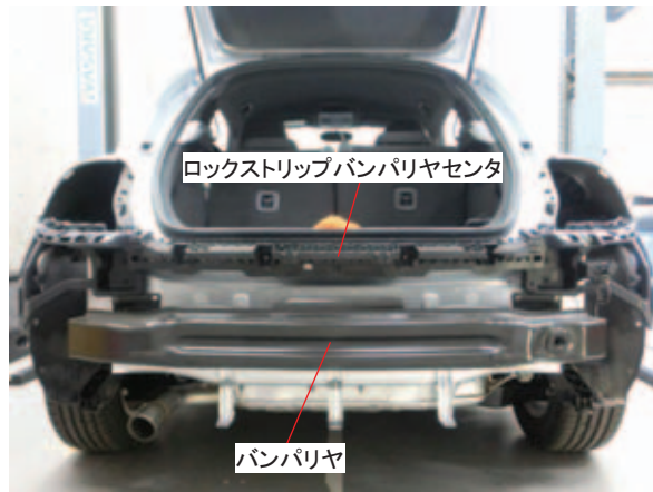
バンパカバーリヤ取外し状態
