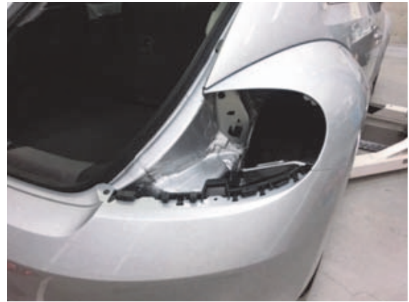
片側テールライト取外し状態
