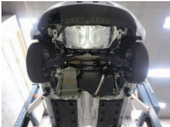
リヤサスペンション取外し状態
