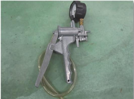
バキュームポンプ：レジンポンプのバキュームポートにつなげて、ひび割れた内部の空気を吸出します。
