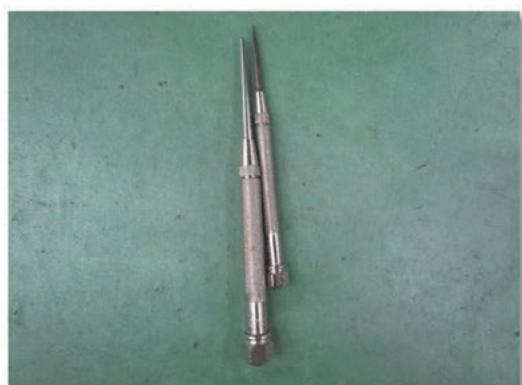
スクライブドライバ：破損部に隠れている傷があるか水分が入っているか、ピットとひびの接続状態がどうなっているかなどをチェックする道具です。
