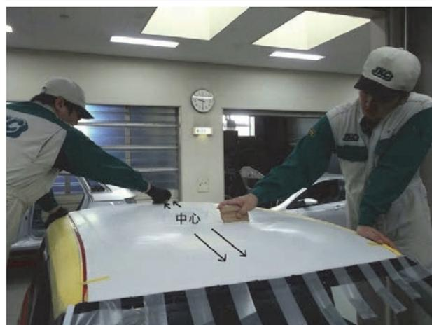
②右図に示す①→②→③→④→⑤→⑥の順序でモールディング中心部から外側にスキージを動かして貼付け
