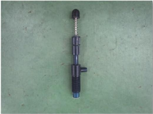
レジンポンプ：ひびの中の空気を吸出して真空状態にし、レジンを入れていく道具です。
