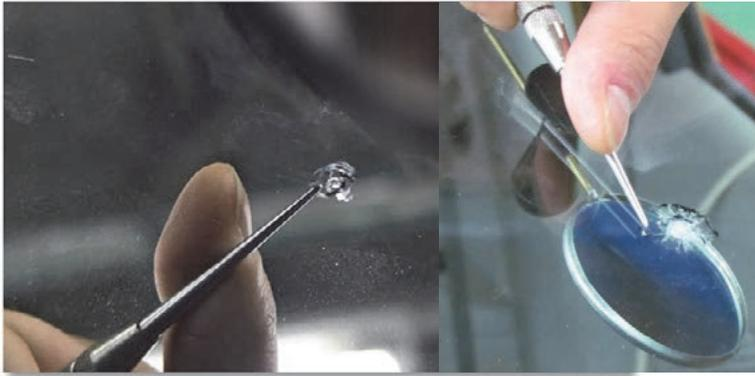
スクライブドライバを使用して、ピット加工後の、ひびの状態を確認しています。樹脂の充てんに際しては、ひびがつながっていないと行き渡らないため、その見極め作業を実施します。衝撃点からひびが繋がっていない場合、樹脂が浸透するようにスクライブドライバを押し込み、ひびをつなげる場合もあります。
