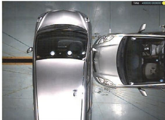
B 車に搭載した加速度計により、0.032 秒 (32ms) 後に 16.7G の最大加速度 (前後方向 : フロアのセンタ X 部) の結果が得られました。
