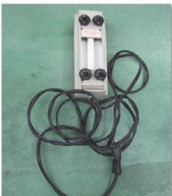
UV ランプ：ガラス表面からレジン硬化させるための紫外線ランプです。
