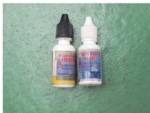
樹脂（レジン、2種類あり）：ノンアクリルレジン（写真右側）とピットレジンスーパーハード（写真左側）があります。ノンアクリルレジンにはひび割れに注入する専用レジンで、ガラスに準ずる屈曲率を持ちます。ピットレジンスーパーハードはガラス表面にできたカケを埋めるもので、板金パテと同様の効果を持つ表面処理用専用レジンです。
