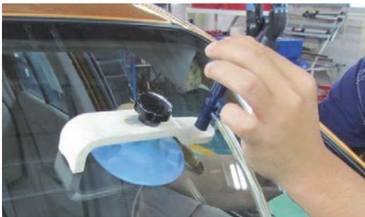
フィクスチャで装着したレジンポンプのプッシュロッドを押し、ロッド頭部を指先で時計回りに回転させながら、プランジャ内のレジン注入圧（加圧）をかけます。
