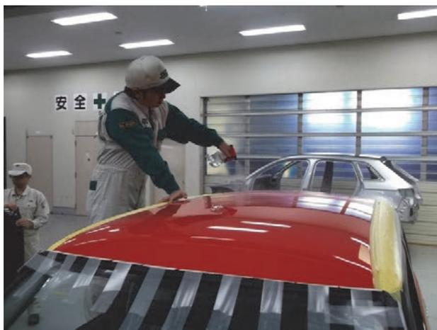
③補給部品をエアブロー後、モールディングの剥離紙を剥がしながら2~4%に希釈した界面活性剤を接着面に十分に吹付ける
