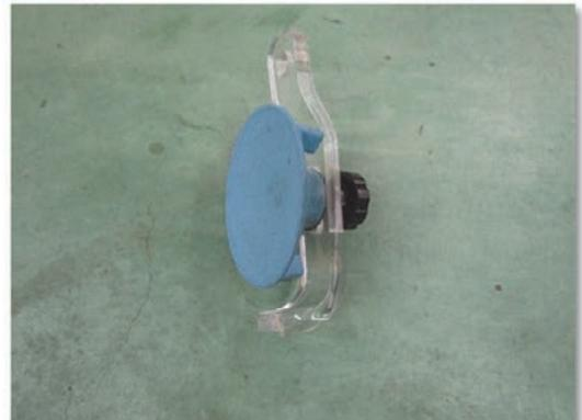
フィクスチャ：吸盤とレジンポンプを取り付けるステー一体構造の道具です。
