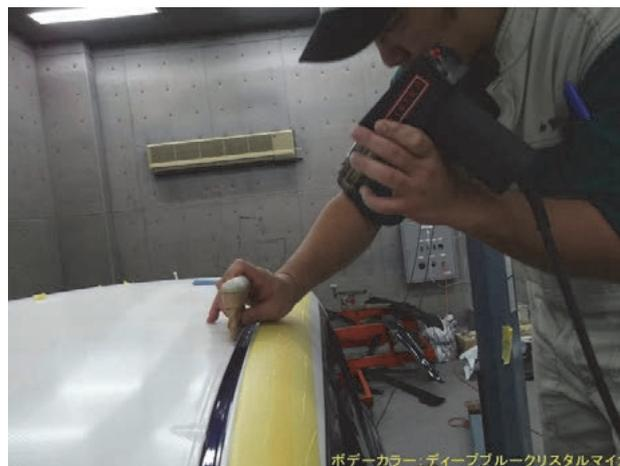
右図の様に①→②→③→④の順に分けてモールディングをドライヤで暖めながらスキージを使用して貼付ける
