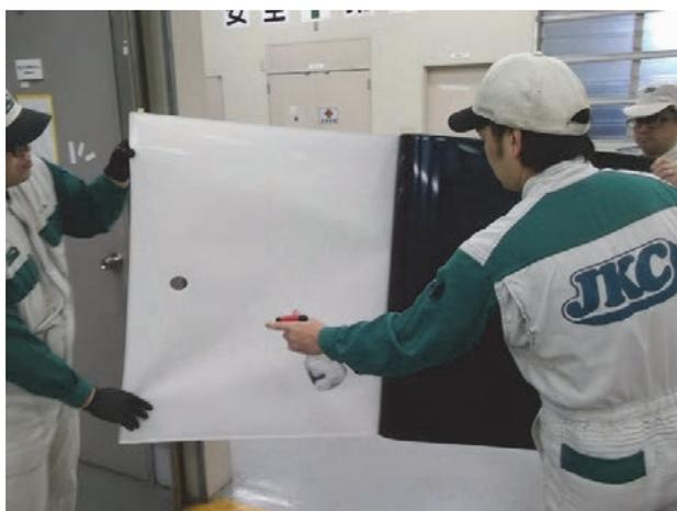
④車両の後端部のコーナ部にモールディングを合わせる
