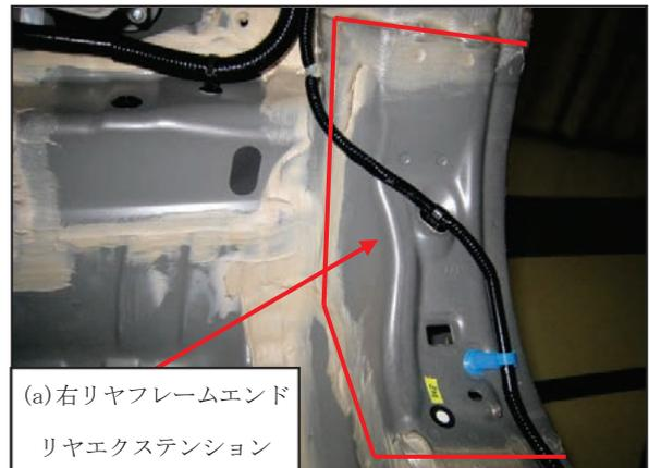
(2) ボデーフレーム修正機への車両取付け
