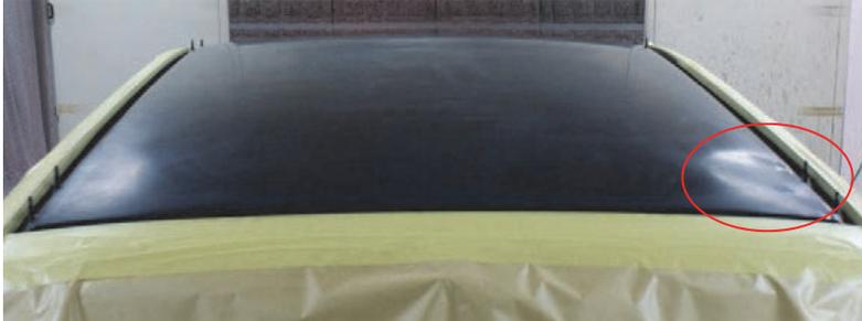
(注) ルーフパネルの一部に凹み損傷がありました(写真○部分)が、取材のため板金修正せずに作業します。
