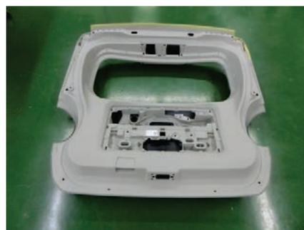
写真4. 樹脂製バックドアパネル補給部品（裏面）
