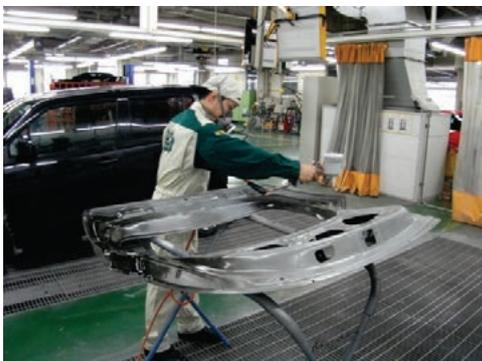
写真 18. 裏面、端部への上塗り塗料の塗布
