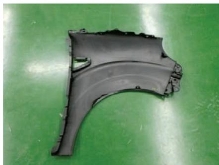
写真2. 樹脂製フロントフェンダパネル補給部品（裏面）
