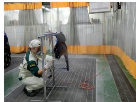
写真 8. 端部への上塗り塗料塗布
