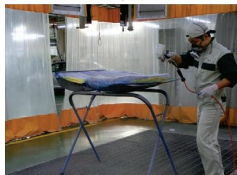
写真 21. 端部への上塗り塗料の塗布
