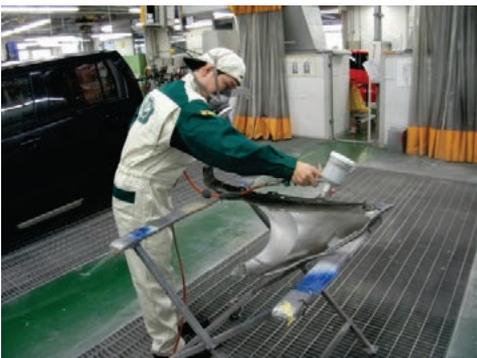
写真 6. 裏面、端部への上塗り塗料塗布
