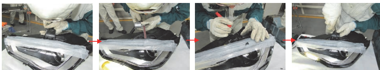
リペアキットに合わせて損傷部 を切断する。 切断後、取付可能な形状に修 正する。 カッタ等で仕上げる。 スクリューで受け穴に取付ける。
