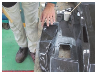
ビニールシートを貼付けて脱泡します。
