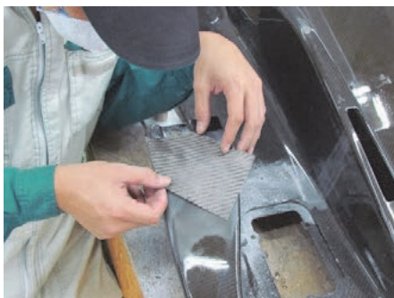
カーボンクロスを補修部に合せます。
