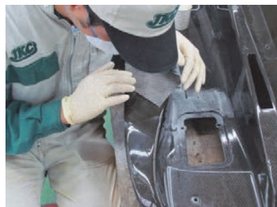
カーボンクロスを貼付けます。
