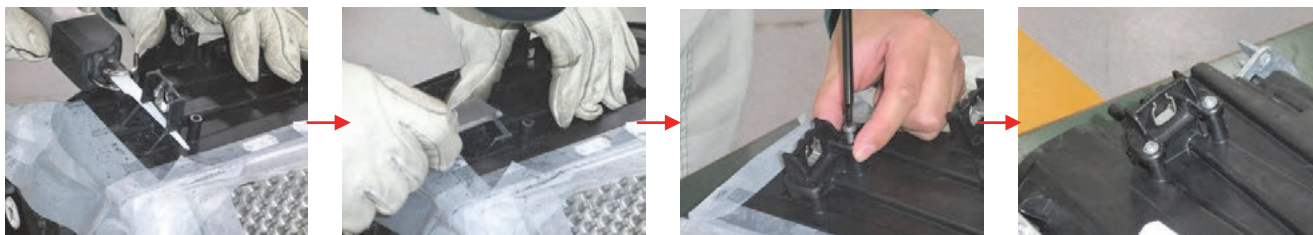
ヘッドライトホルダセットに合わせ て損傷部を切断する。 カッタ等で微調整をする。 スクリューで受け穴に取付ける。 完成。
