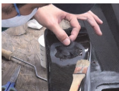
樹脂を塗布後、カーボンマットを更に上から貼付けます。
