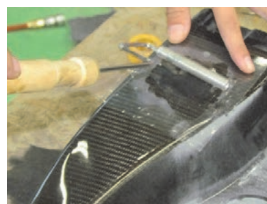
脱泡ローラで空気を除去します。
