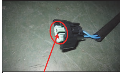
⑱フロントリレーナーを取付ける
