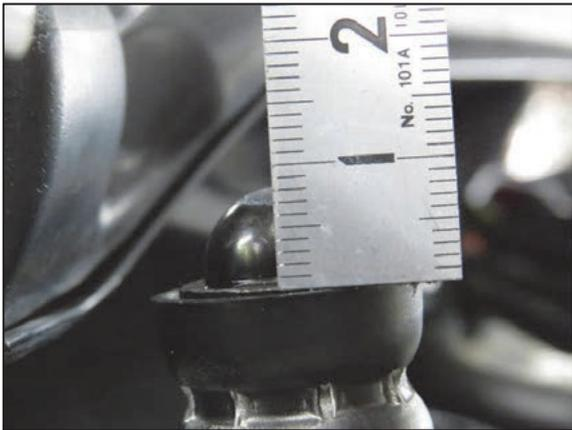
フードリフタ上端の高さは約 8 mm なので、18 mm (粘土とリフタ上端部分) - 8 mm (リフタの上端部分) = 10 mm (粘土)
