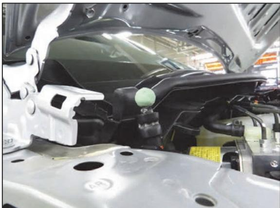
隙間を確認するために粘土をポップアップフードリフタ Assy の上端に乗せます。左右とも行います。
