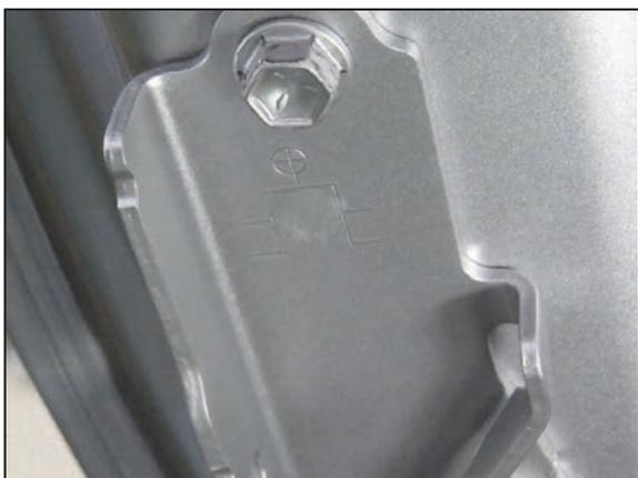
フードを開け、フードヒンジの刻印の範囲内に、粘土が付着していることを確認します。写真は右フードヒンジです。刻印中央に粘土の痕が確認できます。
