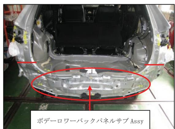
(e) 左クォータパネルエクステンションアウトが左側に移動しています。
