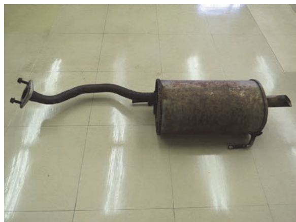
日産マーチ (K13) マフラー 全体に赤錆び多い (機能上は問題なし)
