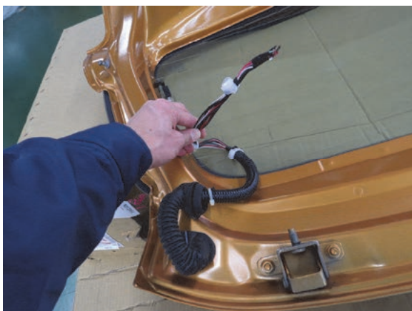
日産マーチ (K13) バックドア 配線が途中で切断
