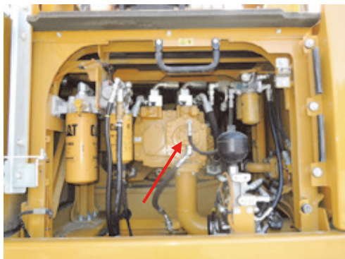
【写真 6】高効率電子制御メイン油圧ポンプ
