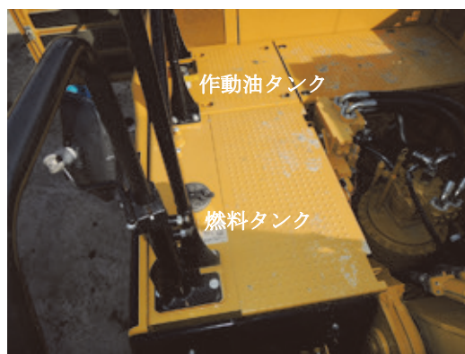
【写真 14】燃料タンク・作動油タンク（上方視）
