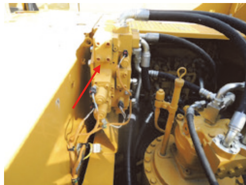
【写真 7】旋回エネルギー再生バルブ
