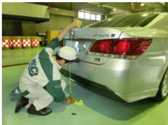
A点を起点として、B点を通るひもを、B点から車両前方5000mm以上の路面に固定し直線を出す
