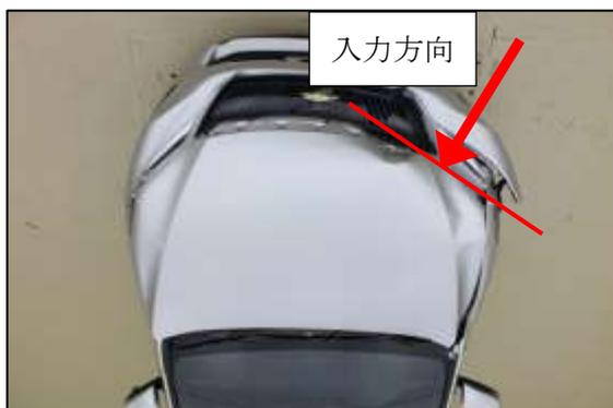
外板パネル損傷傾向、特にフードサブ Assy の折れ方向から、衝撃力の入力は1時方向と判断しました。
