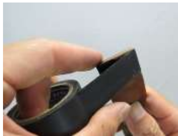
工具もテープなどで養生しておく目安です
