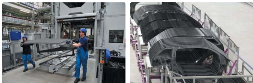
完成したCFRP製のパネルは、不要部分の切断と穴あけ加工が施される。
