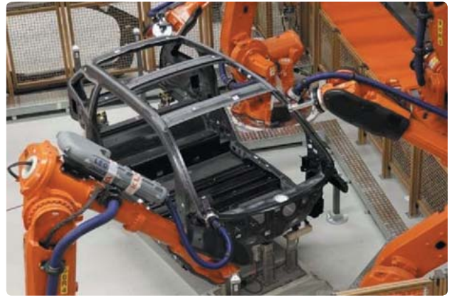
CFRP製パネルの組立てラインの様子
