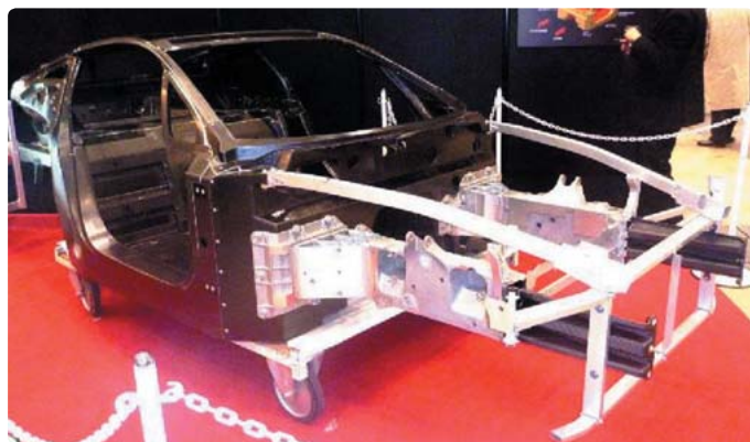
レクサスLFAのホワイトボデーとBピラー付近の様子。プリプレグ、RTM、SMCが混在。
