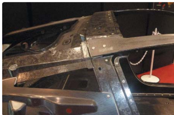
レクサスLFAのホワイトボデーとBピラー付近の様子。プリプレグ、RTM、SMCが混在。
