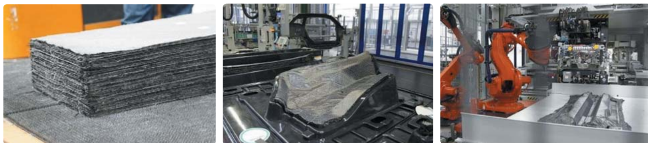
積層、裁断されたCFを金型プレスで予備成形し、樹脂を注入して繊維と樹脂を結合させる。
