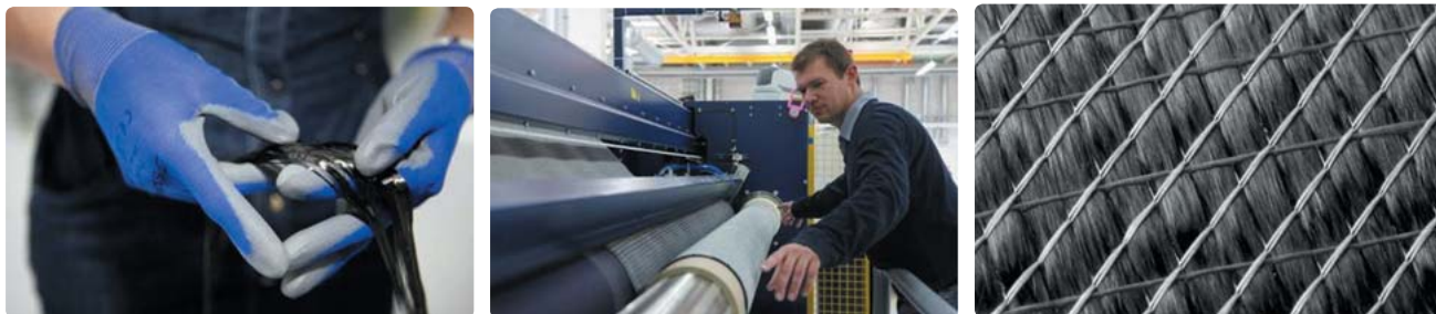
CFを撚り合わせて荒糸を作り、それを織って布状にすることで構造体の原料になる。
