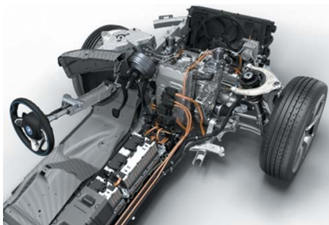
i8のドライブモジュール（一部ライフモジュールを含む）
