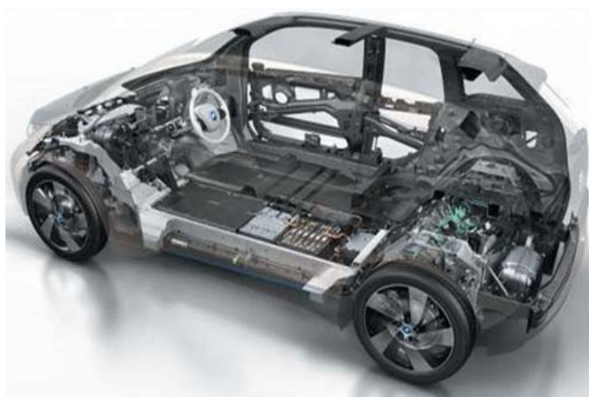
i3のドライブモジュールとライフモジュール
