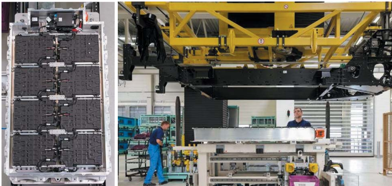
i3のバッテリーと生産ラインでの様子（フレームにバッテリーを組付ける作業）
