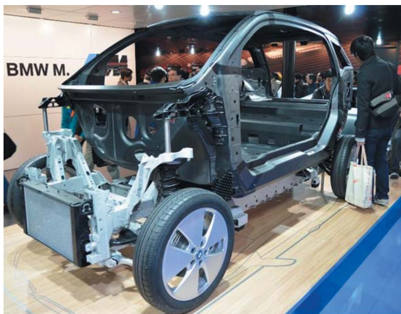
ライフドライブ・コンセプト。トラックの「フレーム」と「キャブ」のように機能が分離され、ドライブモジュールに駆動機構一式が、ライフモジュールには客室と荷室が集約される。
