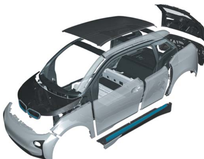
i3の熱可塑性プラスチックによる外皮構造
