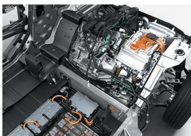
i3のレンジエクステンダ仕様。モータ横にエンジンを搭載するが、エンジンは発電専用
