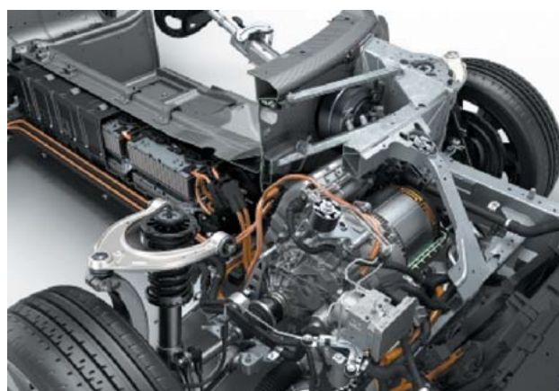
i8のドライブモジュール（一部ライフモジュールを含む）
