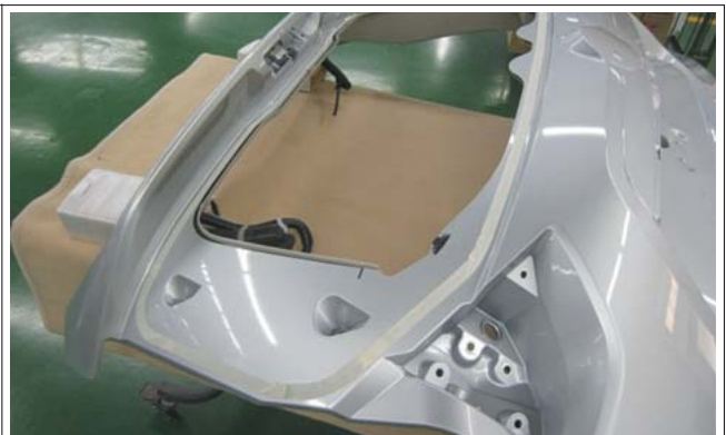
(2) ガラス用のプライマを塗布する部位は、マスキングで養生されています。
