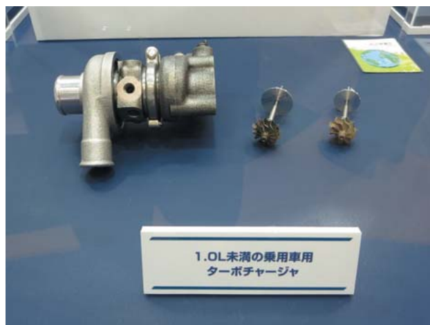
小型高性能ターボチャージャ（三菱重工業株式会社） 更なるダウンサイジングや、排気量1.0ℓ未満の小型車対応のため、現行機種に対し直径を80%以下に縮小した超小型ターボチャージャを開発中。
