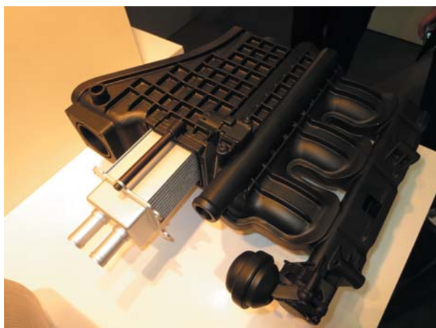
インテークマニホールド内蔵型水冷式インタークーラ（マーレベアージャパン株式会社） 水冷式チャージエアクーラを収める3気筒エンジン用の樹脂製サージタンク。
