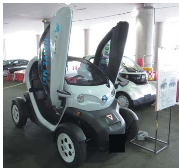
日産 ニューモビリティコンセプト 乗車定員 2名 最高速度 80km/h 航続可能距離 100km/h バッテリー リチウムイオン電池
