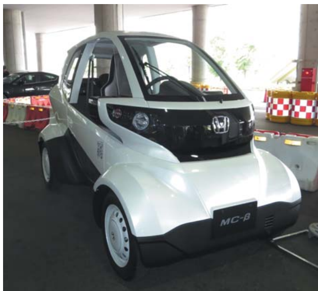
ホンダ MC-β 乗車定員 2名 最高速度 70km/h以上 航続可能距離 80km以上 バッテリー リチウムイオン電池
