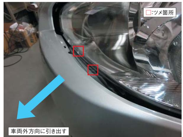
④フロントバンパフェーシアを車両前方に引き出しながら取外します。
