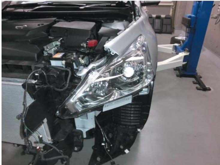
①ヘッドランプ Assy を固定しているボルト 4 本を取外します。ヘッドランプ Assy 突起部のフロントフェンダはめ込み部 1 箇所を取外します。
