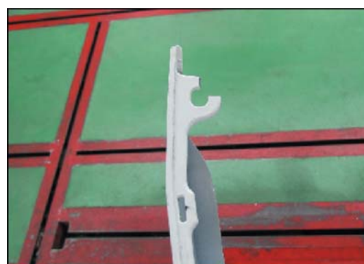
損傷頻度の高いバンパ端部
