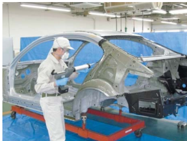
リアフェンダ取替作業
