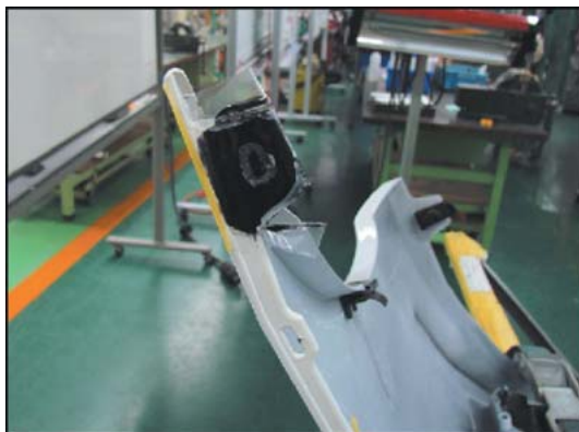
補修用樹脂で欠損部分を成型
