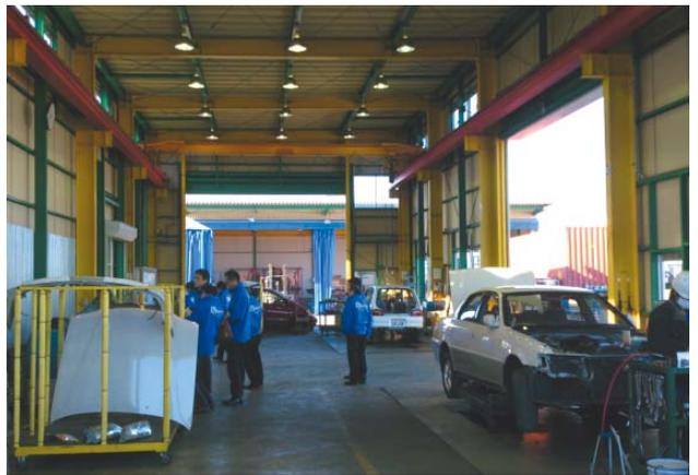
車には高価な「レアメタル」が使用されています。部品として再利用できなくても、マテリアル(原材料)として活用できる部品が多数あり、これらも個々に分別され回収されます。CPUの基盤からは純金が回収できますし、ハイブリッド車に使用されているモータからは、高価な「ネオジム磁石」が材料資源として回収され、再利用されています。
