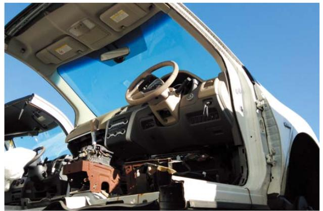
購入した車両を分解する「分解作業場」の様子です。作業場はオイル汚れなど皆無で、整理整頓が行き届いた空間になっています。分解作業場に運び込まれた車両は、個々の部品を全て手作業で取外し(分解)され、市場のニーズにあった部品だけが【リサイクル部品】として販売されます(市場のニーズにあった部品だけが選定・販売されるため、すべての部品が商品になるわけではありません)。
