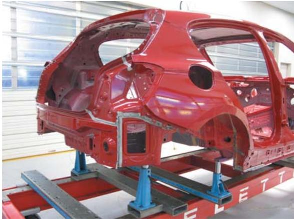
※リヤフェンダを取替える際の各カット位置には、補強板が部品設定される。
