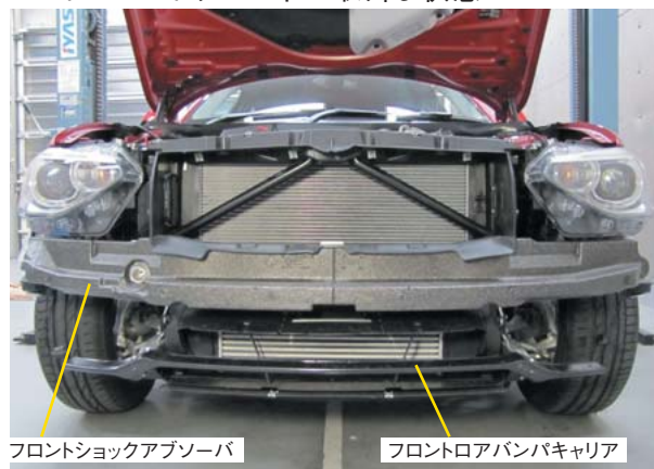
ラジエータエアガイド、ロアエアガイド取外し状態
