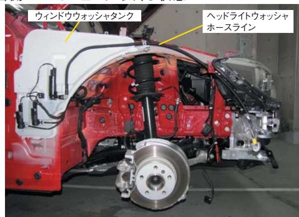
右側フロントフェンダ取外し状態
