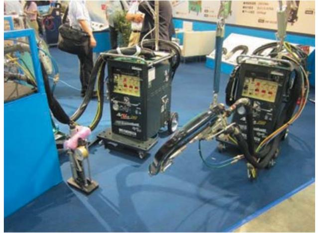
全体のトレンドとしては、自動モードもしくはそれに準ずる簡易な溶接条件の入力アシスト機能を設け、作業者の負担を軽減する機能を搭載した機種が目立ちました。
