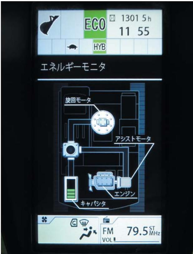
(13)整備や事故修理などにより、高電圧に関わる部位の分解などが必要な場合、キャパシタユニットのLEDインジケータの確認と共に、キャパシタの強制放電を行う必要があります。
