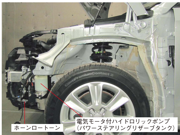
左側フロントフェンダ取外し状態
