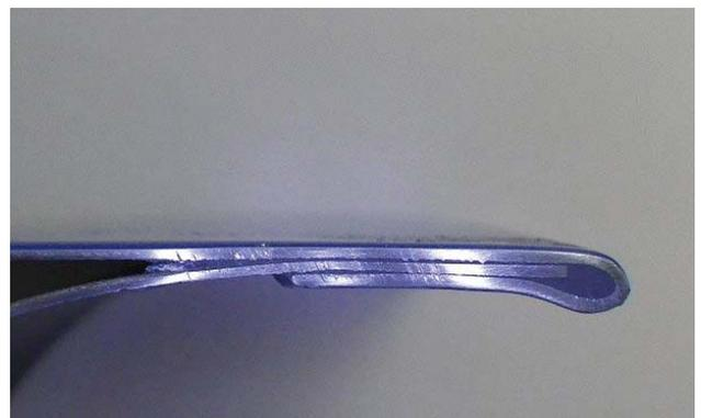
写真4 ヘミング加工例(断面)
