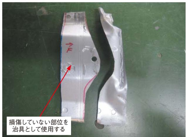
(7)右フロントフレームサイドフロントCOMPを治具に沿って切断します。
