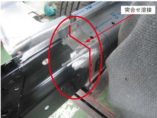
(14) 半裁した右クロージングプレートを突合せ溶接します(右フロントホイールエプロンCOMPは上側に持ち上げた状態)。
