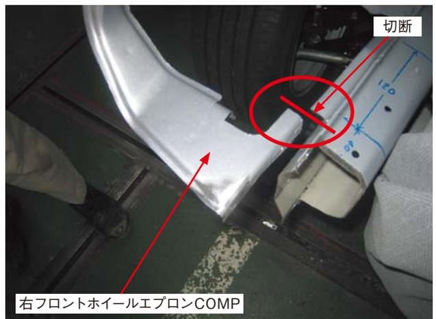
(5)切取った右フロントフレームサイドフロントCOMPを切断して治具を作成します。
