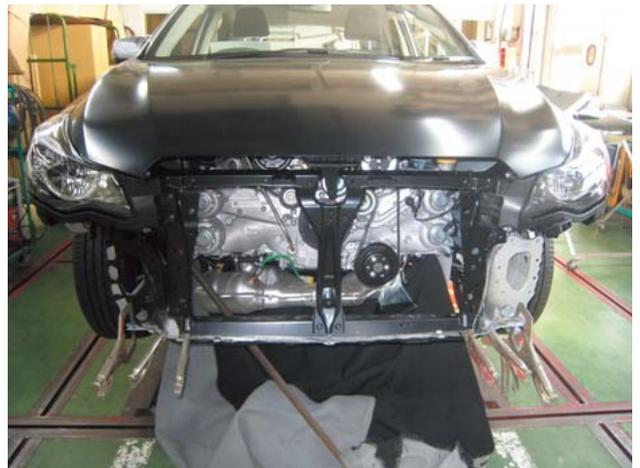
(17) 左右ヘッドランプ、左右フロントフェンダCOMPを取外し、ラジエータパネルCOMP、ラジエータロアフレームCOMPを本溶接して内板骨格取替作業は終了です。
