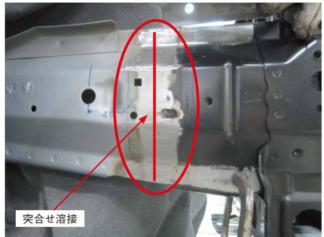
(15) 右クロージングプレート上部を溶接するために一部切断した右フロントホイールエプロンCOMPを突合せ溶接します。
