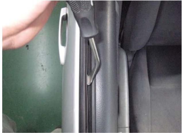
6. ベルトモールにリムーバーのフック部を引掛け(写真 9)、車両側面方向(写真 10 赤矢印方向)にリムーバーを傾け、ベルトモールとツメの間にクリアランスを設けた状態でベルトモールを上を持上げてツメ A を外します。
