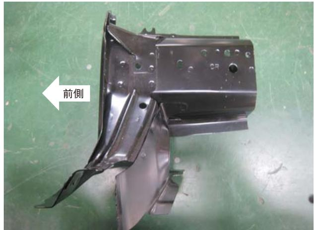
(9)右クロージングプレートを治具に沿って切断します。
