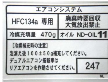
写真11 トヨタ プリウス(30系)の例
