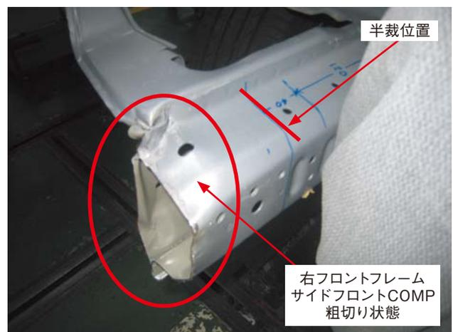
(1)右フロントフレームサイドフロントCOMPのラインフォースを中央で切断します。
