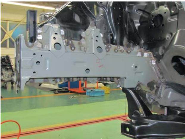
ラジエータサポートサブ Assy アップ、ラジエータサポートサブ Assy、ラジエータサポートサブ Assy ロワーを取付けて溶接系の修正作業は終了です。
