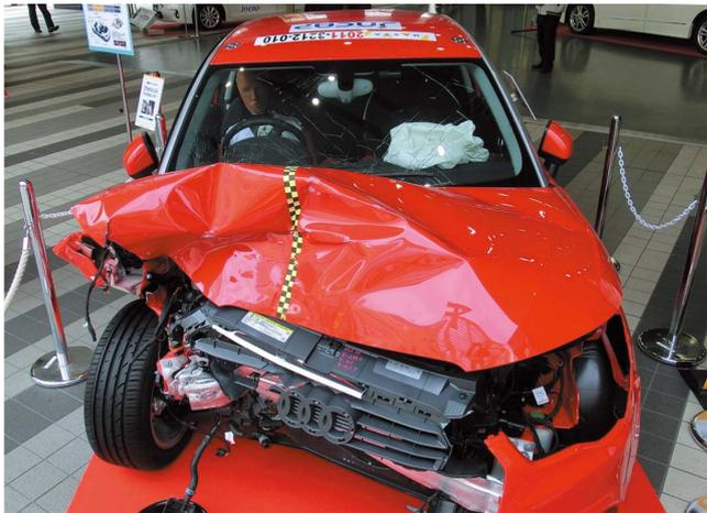
**オフセット前面衝突試験実施車両**
